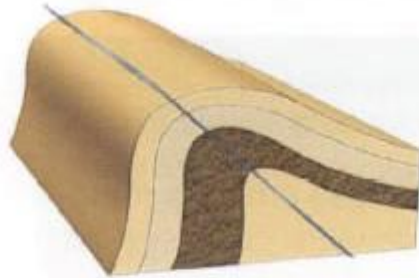
Inclinat. El pla axial està inclinat.
