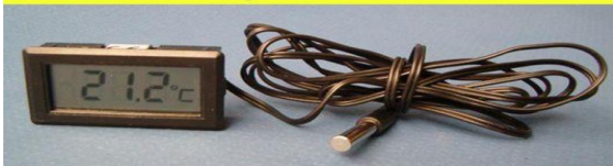
Termòmetre digital amb sonda externa
