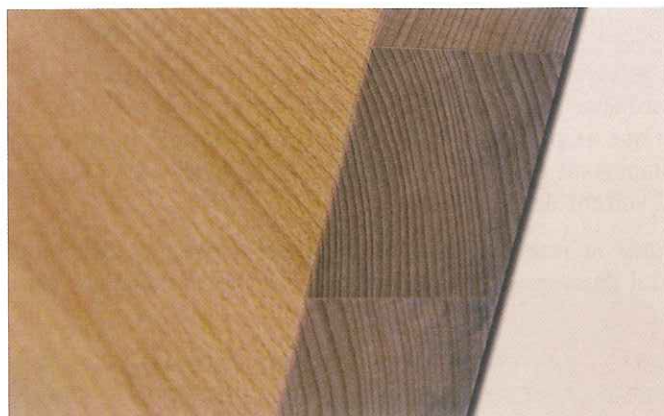
Fig. 9.20. Tauler enllistonat sense revestir.
