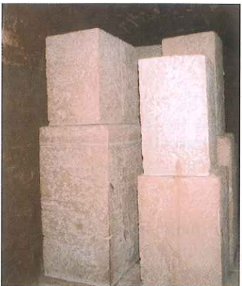
Fig. 9.25. Bloc de ceràmica refractària.
