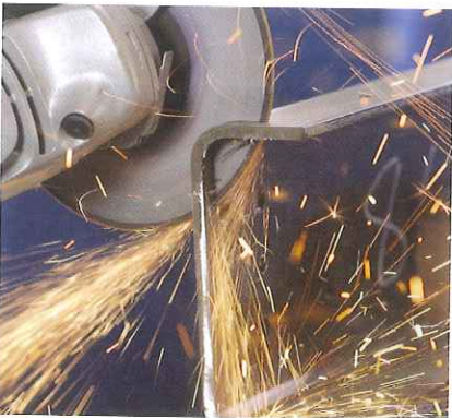
Fig. 9.28. Mola de disc tallant un metall.
