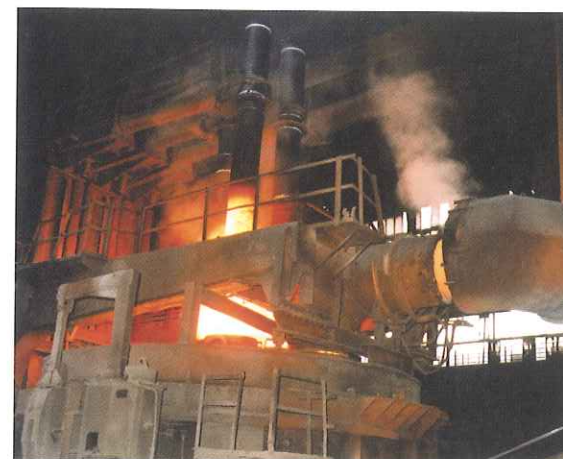
Fig. 7.25. Forn elèctric on es poden observar els elèctrodes incandescents.
