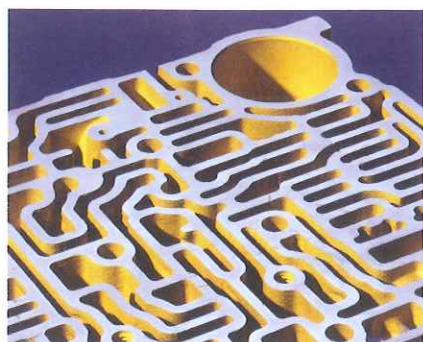
Fig. 7.17. Les peces amb formes complicades, com ara blocs i bancades, se solen fabricar amb foses.
