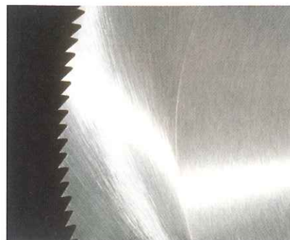
Fig. 7.15. Les eines de tall estan fabricades amb acer amb alt contingut en carboni (de 0,6 a 1,4%); això els proporciona una gran duresa i resistència.
