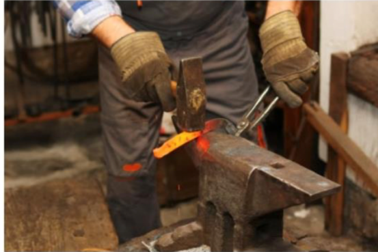
Un ferrer elabora una ferradura forjant una tira d'acer.
