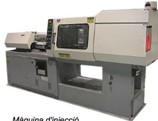
Màquina d'injecció per a la fabricació de peces de plàstic.
