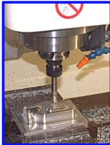
Mecanitzat d'un motlle.
