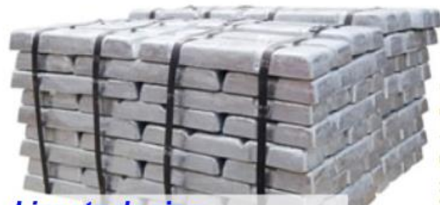
Lingots de zinc Són blocs obtinguts d'abocar el metall líquid en motlles.
