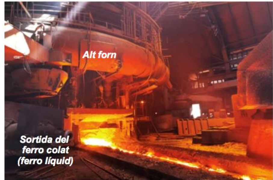
Sortida del ferro colat. La seva temperatura arriba als 1800 °C.
