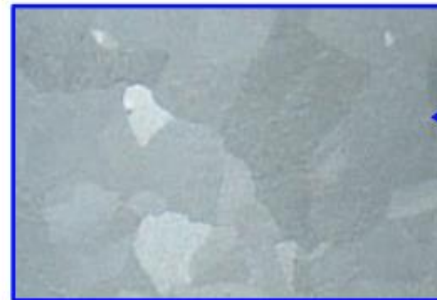
Fanal d'acer galvanitzat i ampliació que mostra els cristalls de zinc que es formen durant el bany en zinc fos.
