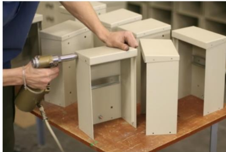
Col·locació de reblons tubulars a la indústria mitjançant una rebladora pneumàtica.
