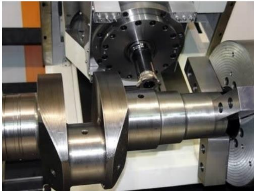
Tornejat d'un cigonyal amb un torn automatitzat.
