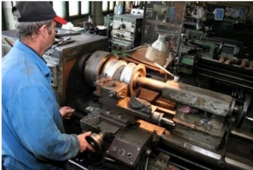
Mecanització d'una politja en un torn manual.
