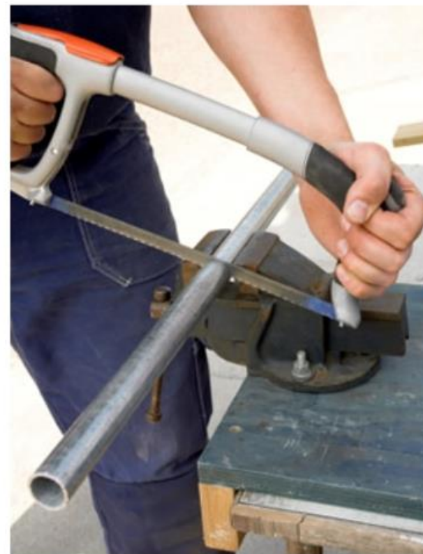
Tallant una barra d'acer amb una serra per a metall. La barra es subjecta en un cargol de banc per evitar que es mogui.
