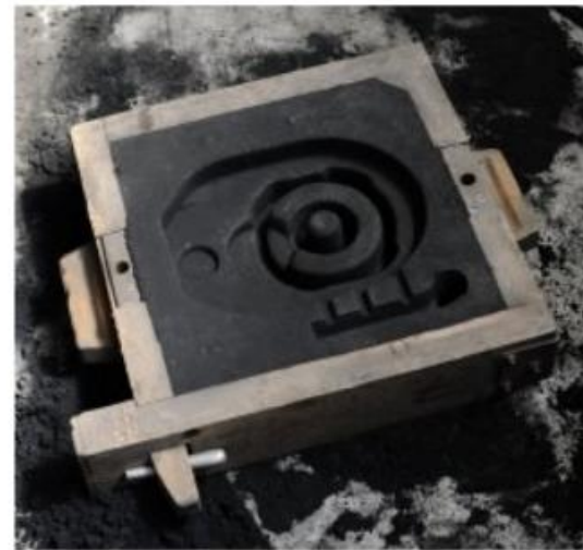
Motlle de sorra. S'hi pot veure una de les dues parts que el formen, un semimotlle.
