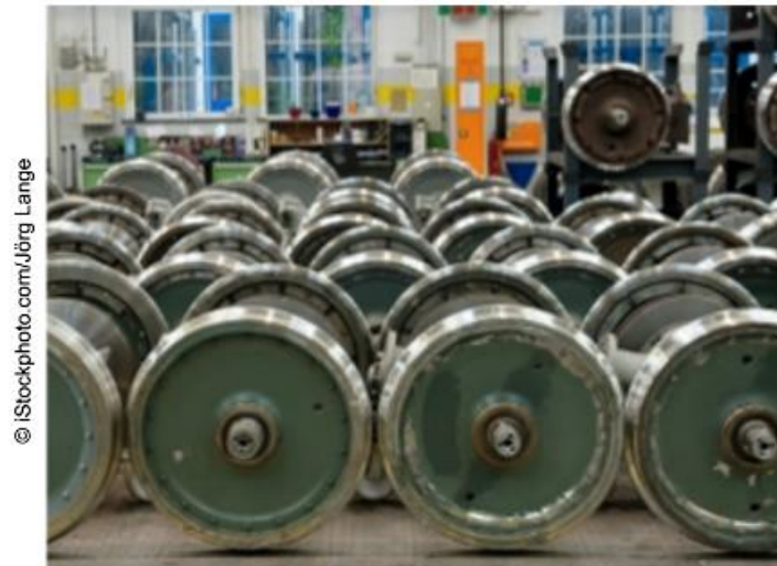
Les rodes dels trens es fan amb forja.
